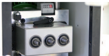
Gręžimo gylio ribotuvas su skaitmenine matavimo skale lengvam ir tiksliam gręžimo pozicijos nusistatymui
