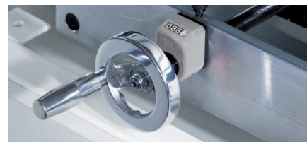
Rankinis reguliavimo ratukas su skaitmenine matavimo skale greitam ir tiksliam gręžimo stalo nustatymui
